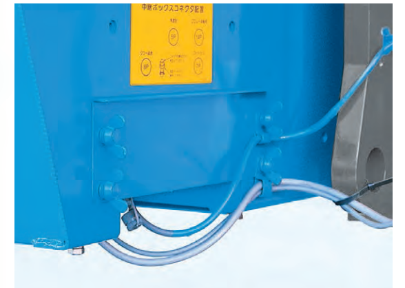
キャブ下にフロント電気配線コネクタを集中
